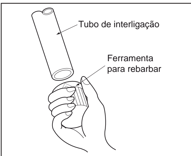
FIGURA 25 - FERRAMENTA PARA REBARBAR
